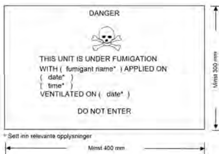
Varselmerke for desinfiserende gass
