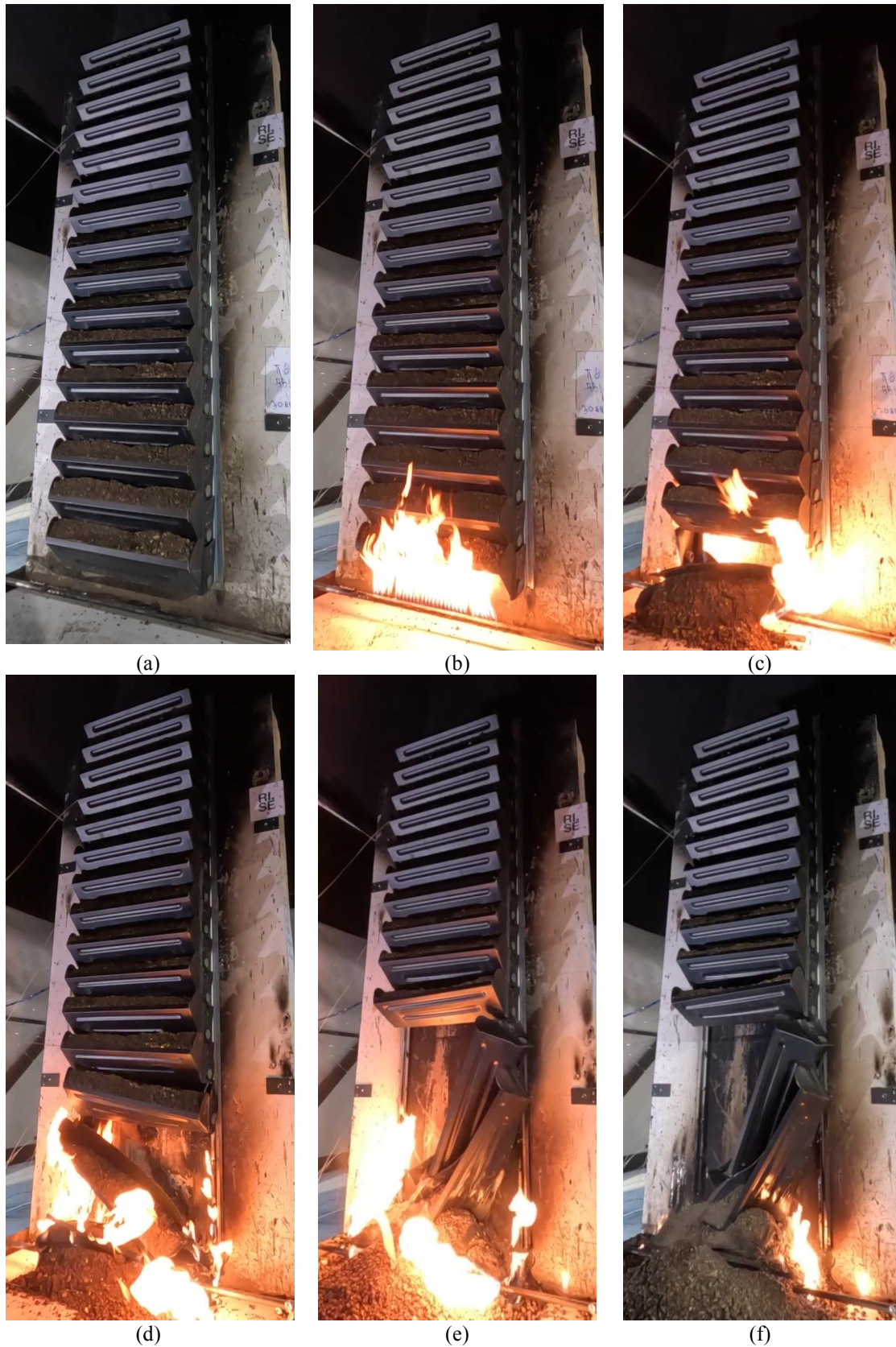
Figur 4-21: Forsøk GV6 med ekstern brannkjelde og brennbart plantesystem utan planter. (a) før forsøksstart, (b) propanbrennar akkurat tent, (c) 2 minutt etter forsøksstart, (d) 5 minutt etter forsøksstart, (e) 20 minutt etter forsøksstart, (f) 21 minutt etter forsøksstart, rett etter gassbrannen vart sløkt.
