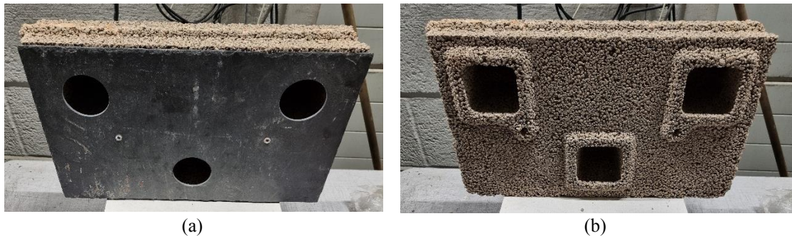
Figur 3-3 Elementa i det ubrennbare plantesystemet. (a) Element med ytre skal av skifer og (b) element utan det ytre skalet.
