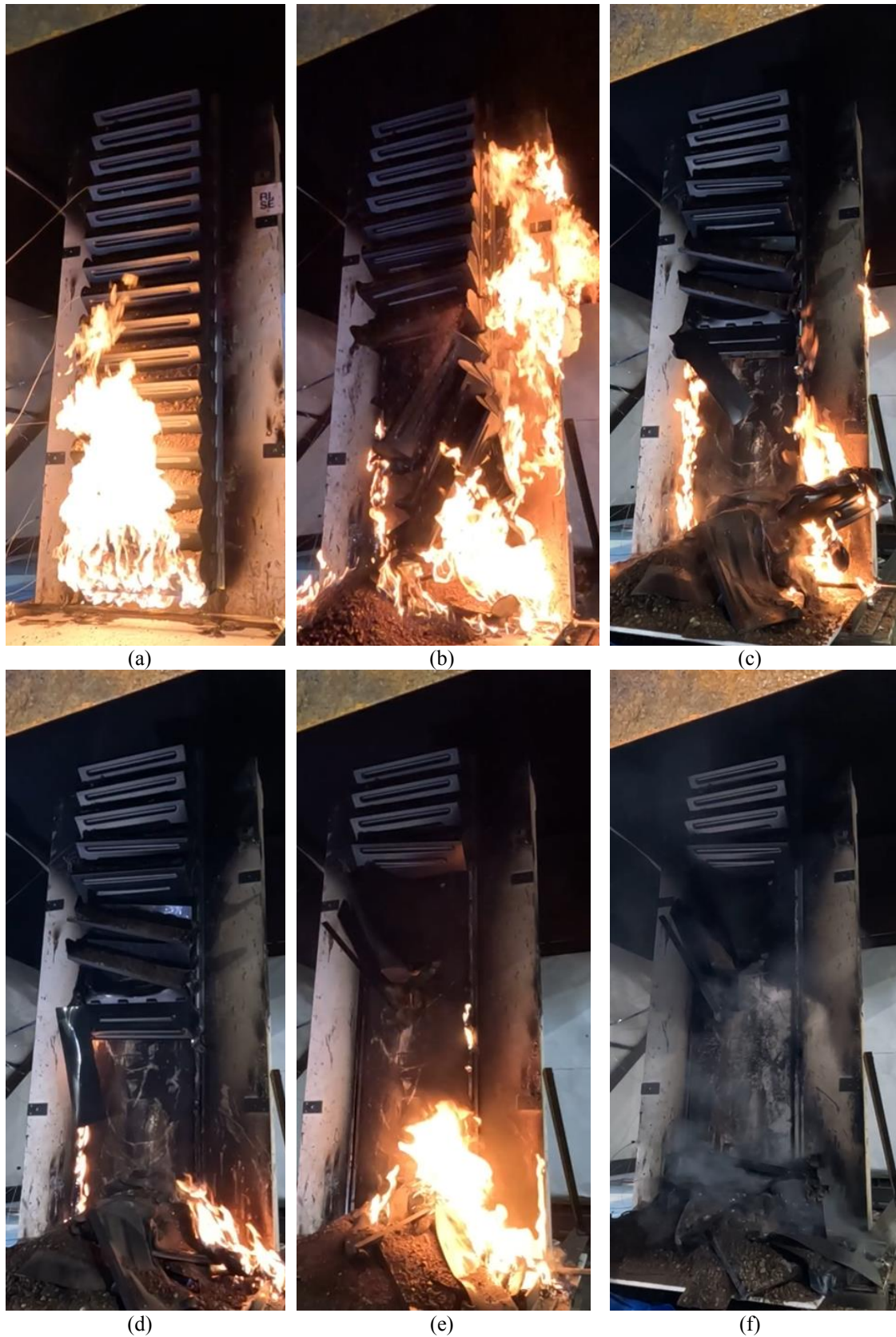
Figur 4-22: Forsøk GV7. (a) Propanbrennar akkurat tent, (b) 2 minutt etter forsøksstart, (c) etter 3 minutt då propanbrennaren akkurat var sløkt, (d) 5 minutt etter forsøksstart, (e) 20 minutt etter forsøksstart, (f) 23 minutt etter forsøksstart då brannen vart sløkt med vatn.
