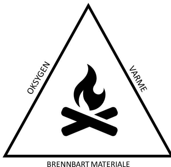
Figur 2-1: Branntrekanten viser de tre viktige elementene som må være til stede for å opprettholde en forbrenning: oksygen, varme og brennbart materiale.
