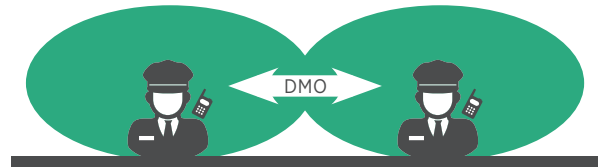
FIGUR 5. DMO benyttes for lokal kommunikasjon uten bruk av Nødnett.
