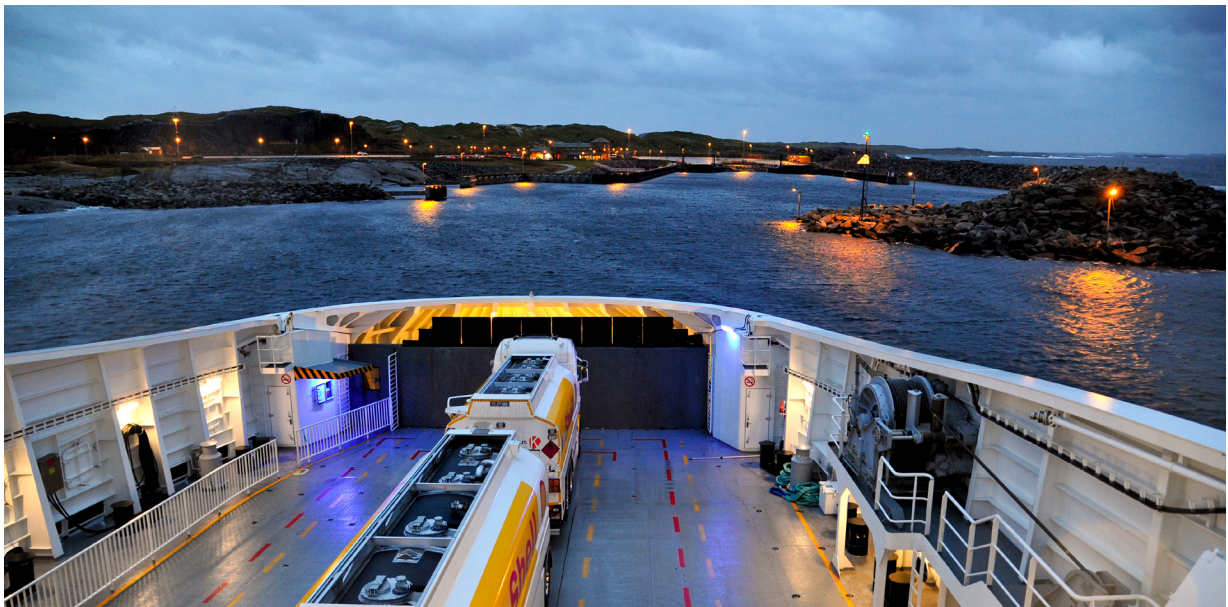
Tankbil fra Esso på fordekket på av ferje som anløper Mortavika på ferjestrekningen Arsvågen-Mortavika på E39 over Boknafjorden i Rogaland. Tankbilen står alene på fordekket pga. regler for transport av farlig gods. Foto: Steinar Haugberg/Samfoto.
