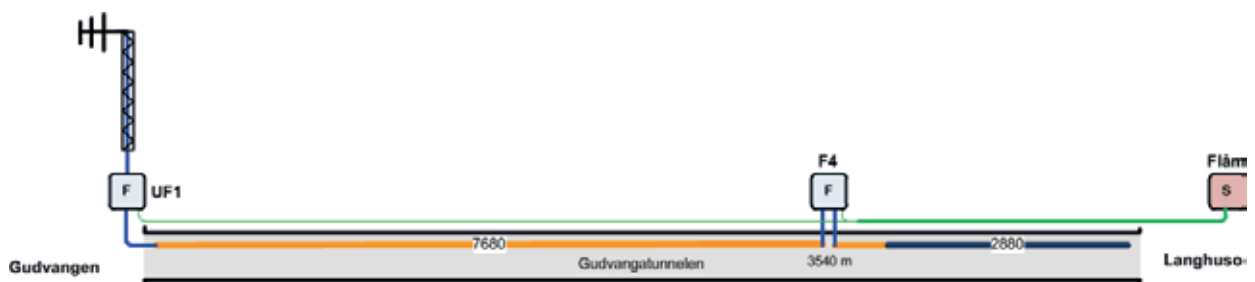
FIGUR 14. Skisse over samband i Gudvangatunnelen (SVV).
