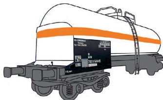
Merke som viser at gasstank har sikkerhetsventil
