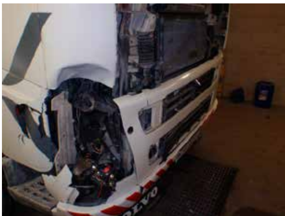
FIGUR 4. Bilde av skade på MEMU F-114 etter elgpåkjørsel.
