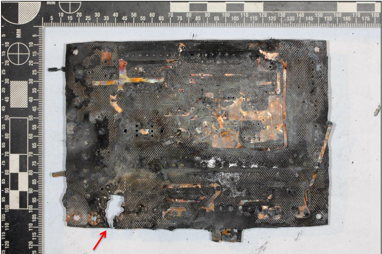
Figur 7. Baksiden av kretskortet. Pilen viser til område med smelteskader.
